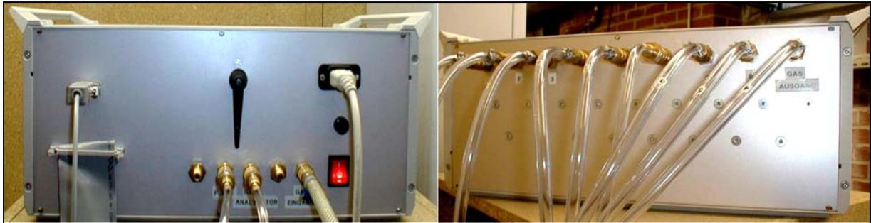
ABBILDUNG 8.30: STEUERGERÄT DES TRACERGASMEßSTANDS IN VORDER- UND RÜCKANSICHT (RECHTS). AN DER RÜCKSEITE WERDEN DIE ACHT KANÄLE ZUR PROBEENTNAHME UND DER INJEKTIONS-KANAL ANGESCHLOSSEN. AN DER VORDERSEITE (LINKE BILDHÄLFTE) BEFINDEN SICH DIE ZULEITUNGEN ZUM GASANALYSATOR BZW. VON DER GASFLASCHE.
