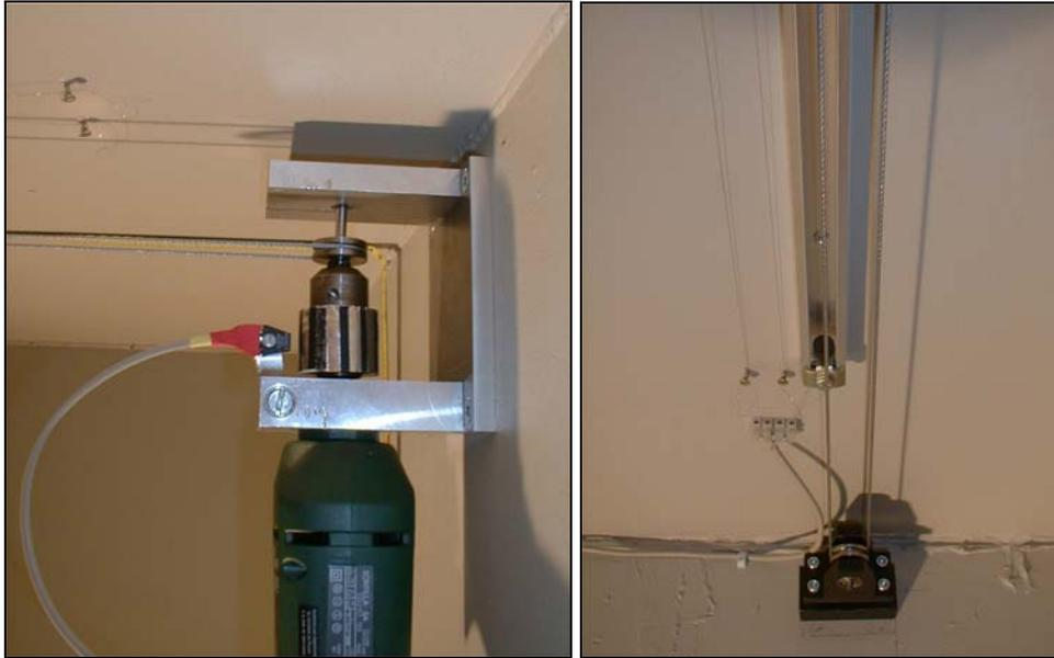
ABBILDUNG 8.22: BOHRMASCHINE ZUM ANTRIEB UND LICHTSCHRANKE ZUM POSITIONIEREN DES RAHMENS. DIE ABSCHLIEBENDE POSITIONSMESSUNG ERFOLGT ÜBER DEN DOPPELT GESPANNTEN KONSTANTANDRAHT. IM RECHTEN BILD IST DER ANSCHLUß ZUR WIDERSTANDSMESSUNG ZU SEHEN.
