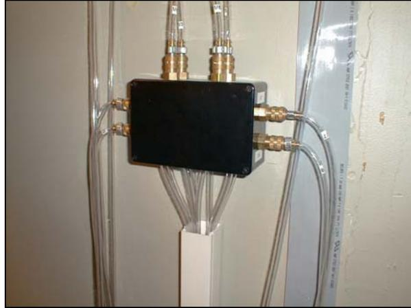
ABBILDUNG 8.24: ZUSAMMENFÜHREN DER GASENTNAHMSCHLÄUCHE IN EINER SAMMELBOX. DIE SCHLÄUCHE UNTERHALB DER BOX WERDEN DURCH DEN KABELKANAL UND ÖFFNUNGEN IN DER WAND NACH AUßEN GELEITET.
