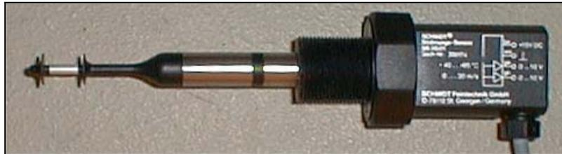
ABBILDUNG 8.5: STRÖMUNGSSENSOREN DER FIRMA SCHMIDT FEINTECHNIK, ST. GEORGEN. ZEHN DIESER SENSOREN WERDEN IN DER KLIMAKAMMER ZUR VERMESSUNG DER RAUMLUFTSTRÖMUNG EINGESETZT.
