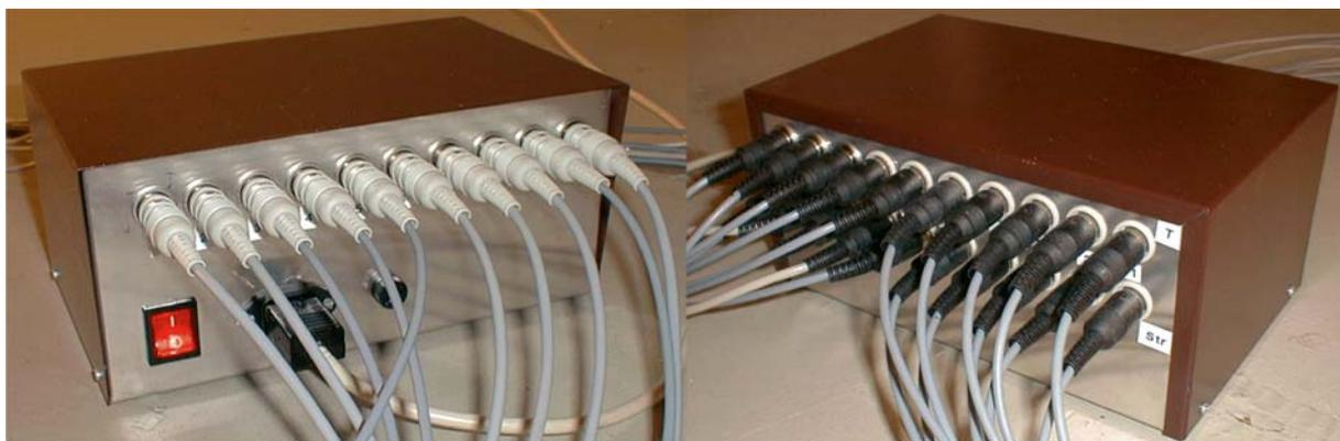
ABBILDUNG 8.23: VERTEILUNGSBOX ZUR AUFTEILUNG DER SENSORAUSGANGSSPANNUNG ZUR TEMPERATUR- UND GESCHWINDIGKEITSMESSUNG.
